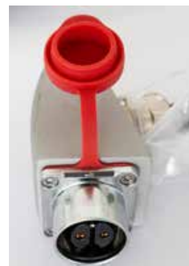
Nouvelle prise de pont étanche disponible sur le NEX e Lite 4.0
