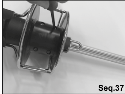
Démonter le tambour. Remove the drum.
