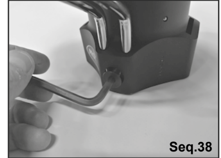
Démonter les bras arceaux. Dismantle the drum cage.
