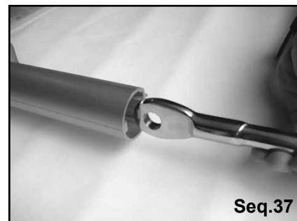
Enfiler le câble dans la gaine coupée. Slide the top extrusion up the forestay.
