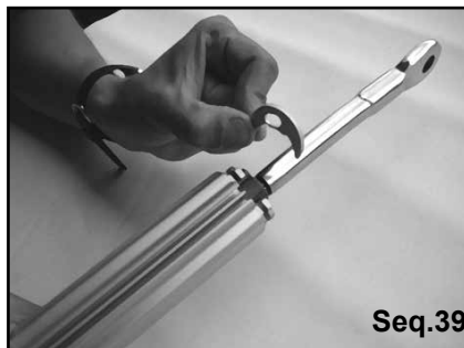
Engager la demi-lune latéralement dans la rainure. Fit the stop washer into the slot in the bearing holder.
