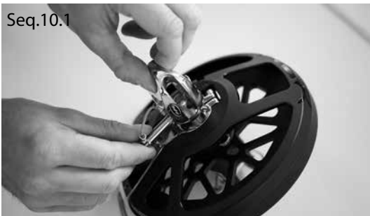
Seq.10.1 Ouvrir l'axe du palan pour l'installer sur la tourelle Open the solid sheave pin to install it on the spool
