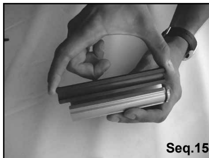
Monter le 1/2 palier dans l'éclisse. Fit one 1/2 bearing into the bearing holder.
