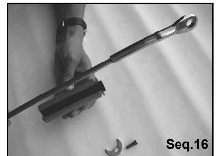
Placer le câble dans cet ensemble. Fit the wire into this assembly.
